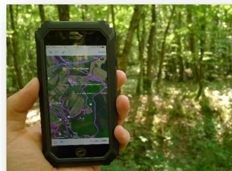
Les logiciels SIG embarqués sur smartphones et tablettes permettent de combiner la précision d'un relevé GPS avec l'utilisation des photographies aériennes.
