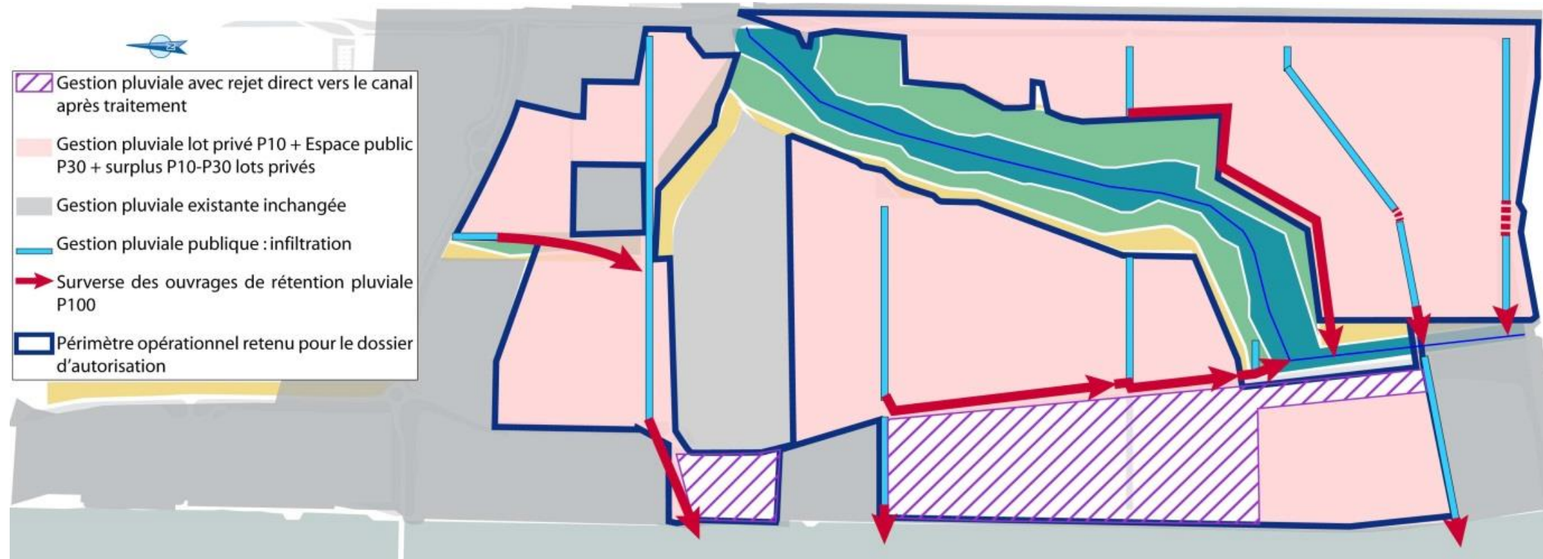
Figure 48 : Schéma de principe des parcours à moindre dommage – fonctionnement des surverses
