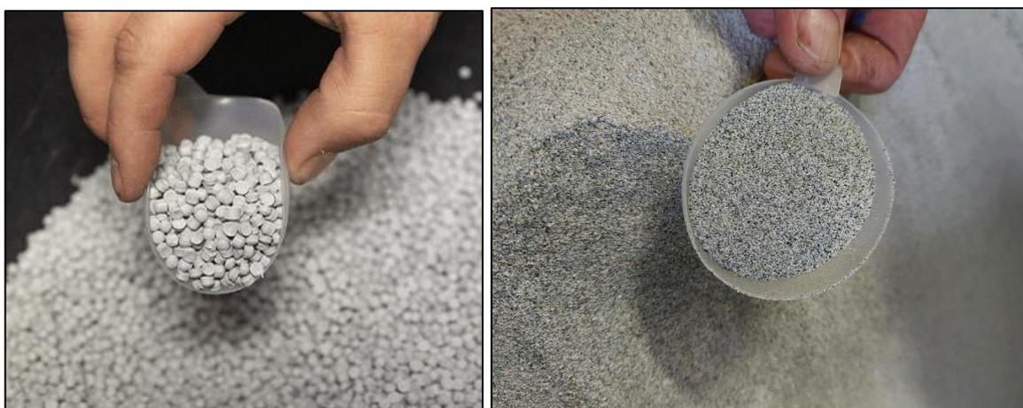
Figure 83 : PVC recyclé par régénération (à gauche) et micronisation (à droite) (©PAPREC)
