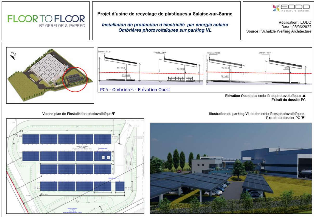
Figure 12 : Illustration de l’installation de production d’électricité par ombrière photovoltaïques
