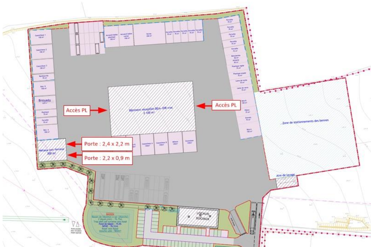
Figure n°1. Localisation des ouvrants
