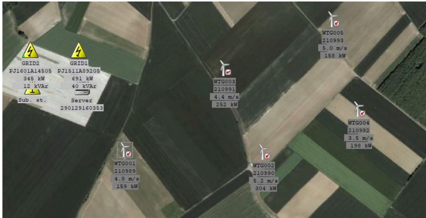
Situation en temps réel d'un parc éolien, production, vitesse du vent et de rotation, orientation, statut des machines, alarmes, etc.
