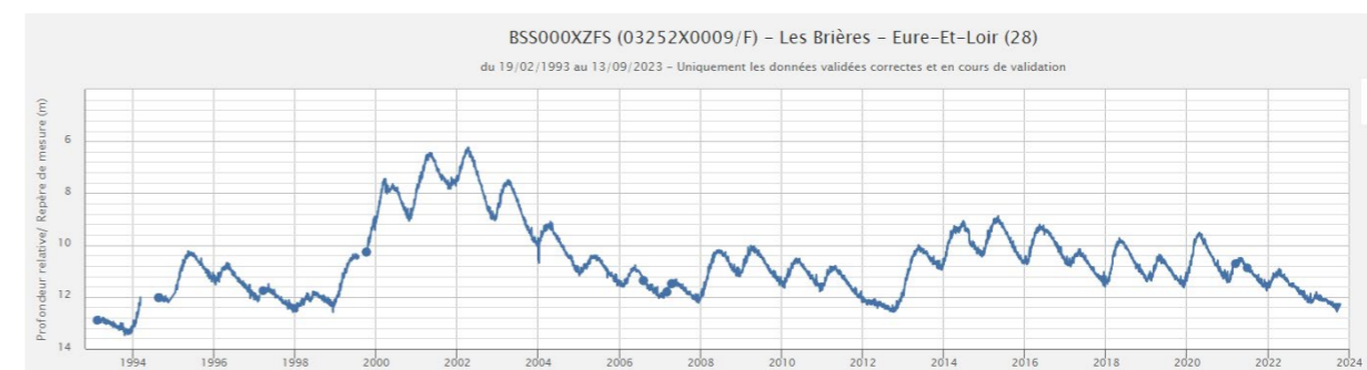
Figure 4 : PROFONDEUR DE LA NAPPE POUR LE CAPTAGE BSS 03252X0009/F
