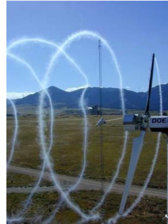
Figure 129 : Effet de sillage derrière une éolienne bi-pale visualisé à l'aide d'un traceur fumée
