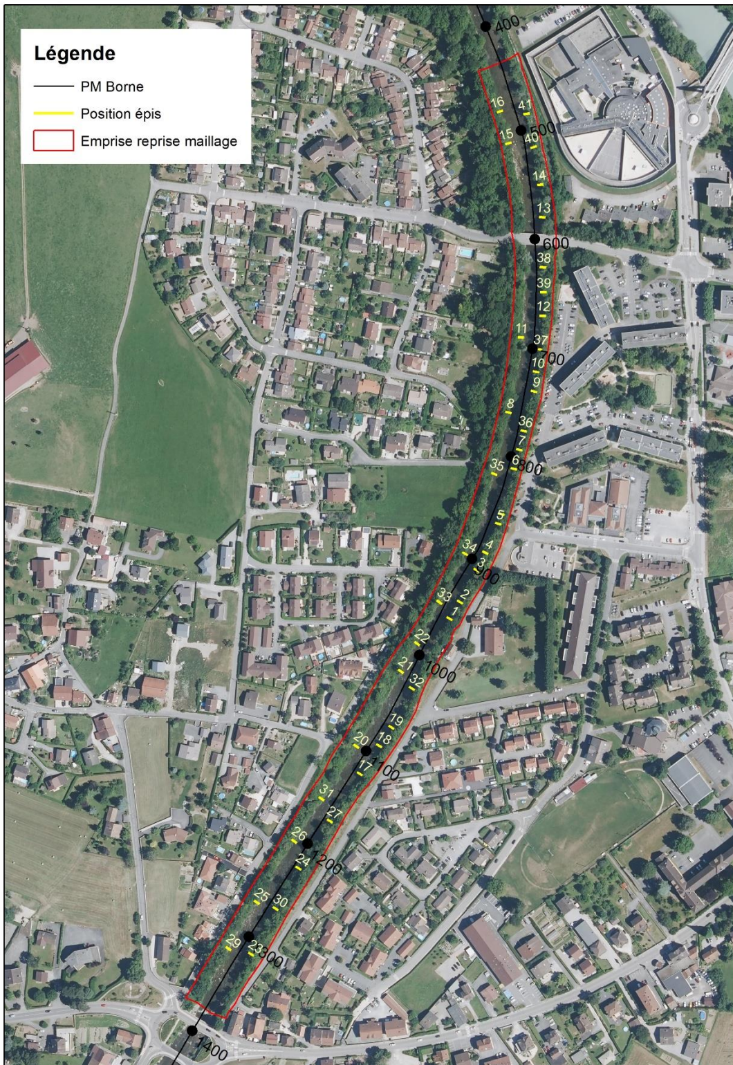
Figure 11 : Vue en plan de l'emprise de la reprise du maillage (rouge) et de la localisation des épis (jaune)
