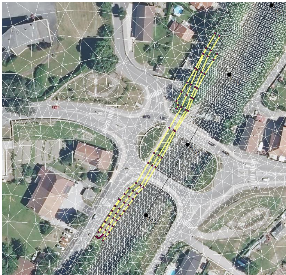
Figure 14 : Vue en plan des lignes 3D (en jaune) pour intégrer la modification de la piste cyclable sous le pont royal
