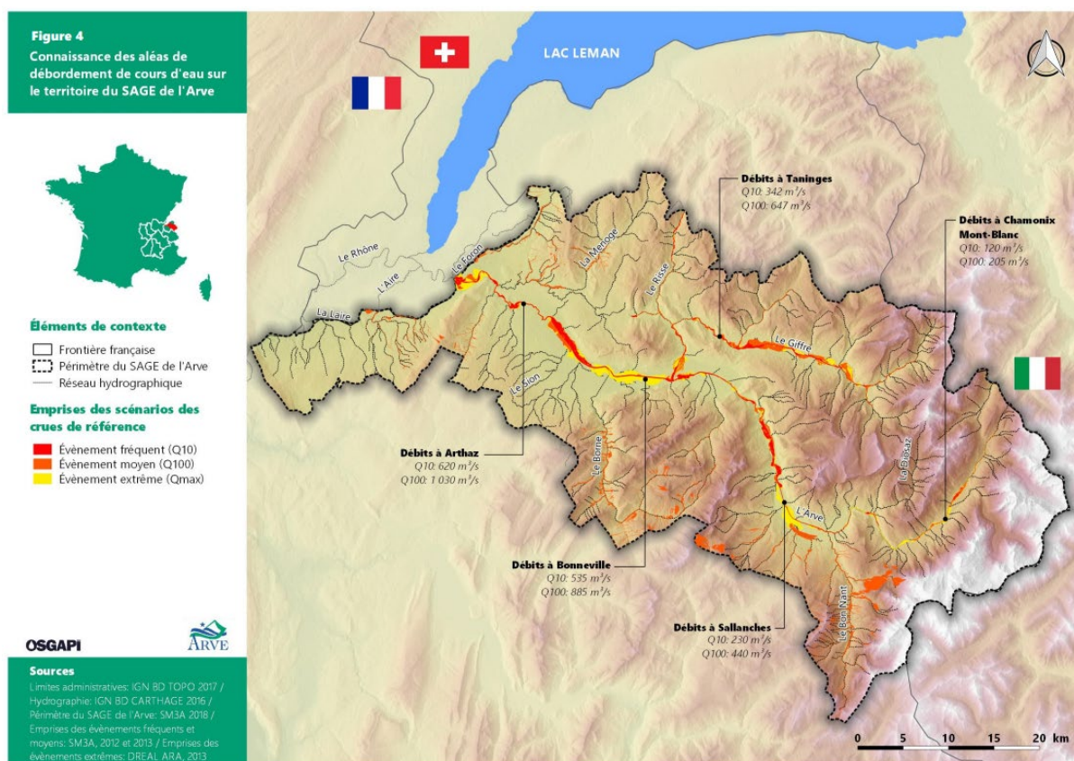
Figure 3 : Aléa de débordement des cours d'eau sur le bassin versant de l'Arve (source PAPI-2020-202)
