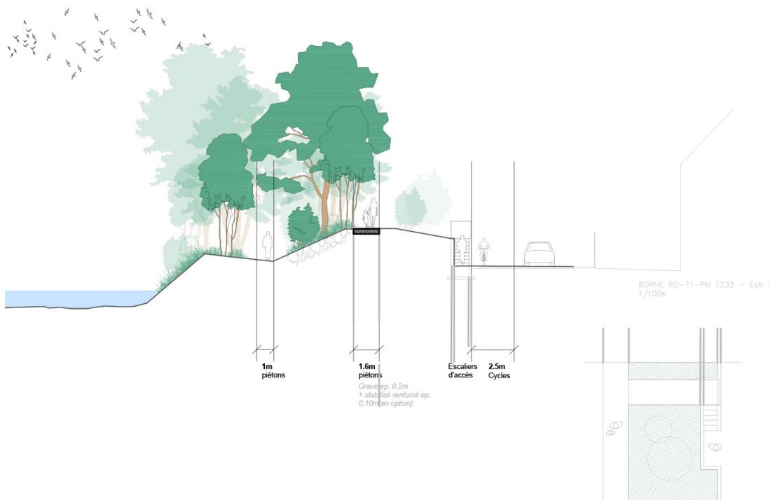
Figure 74 : Profil type RD-T1 et vue en plan des escaliers d'accès
