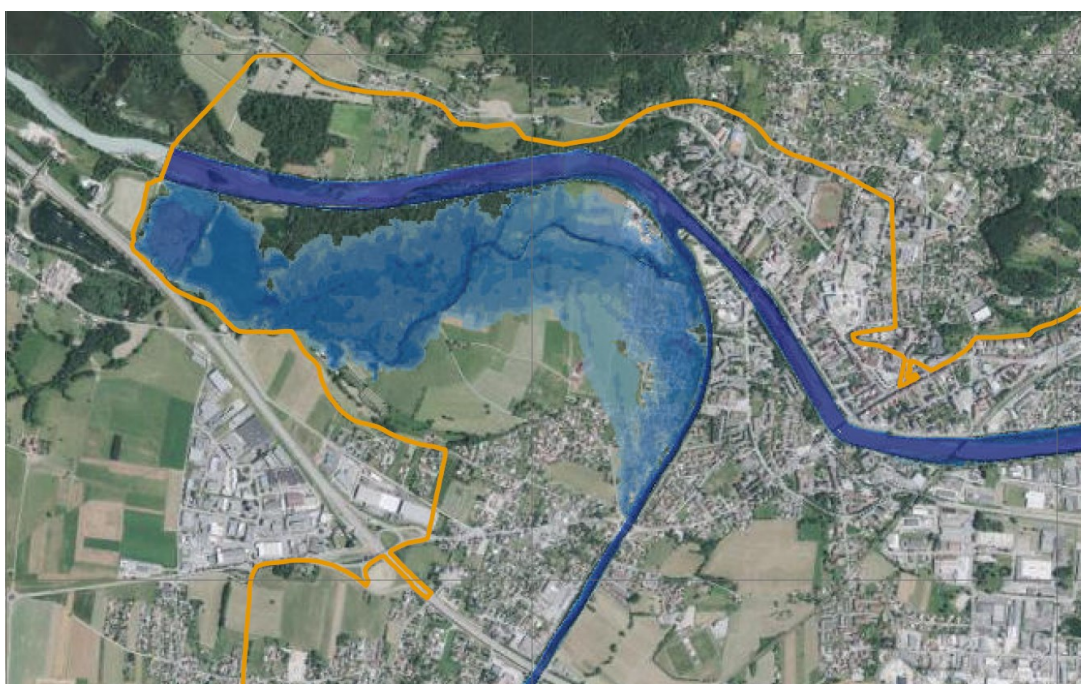
Figure 23 : Modélisation hydraulique (Q100 Borne et Q30 Arve) – digues du Borne rive gauche effacées
