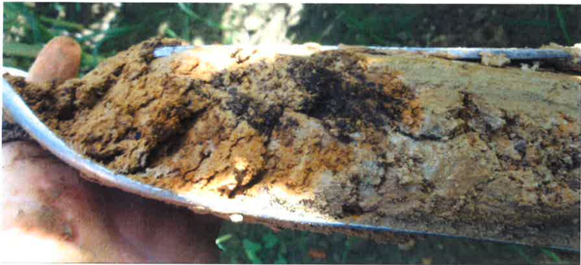
Limon bariolé ocre/beige, avec des concrétions noires de Manganèse (sondage S4)
