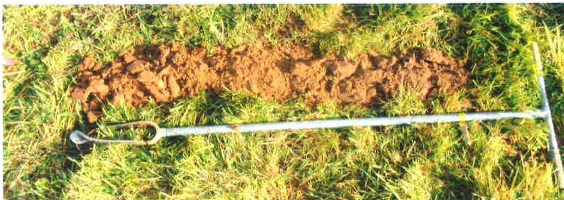
Limons de couleur homogène : sol sain, sans trace d'hydromorphie (sondage n°1)
