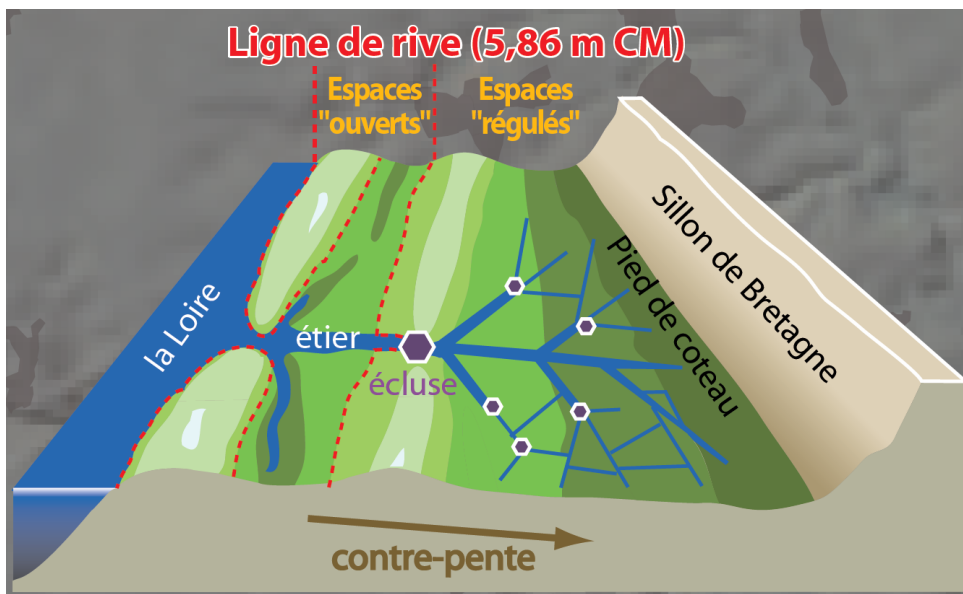
Figure C.23 : Schéma des marais situés sur les berges de l'estuaire de la Loire. Source : GIP Loire Estuaire, 2010
