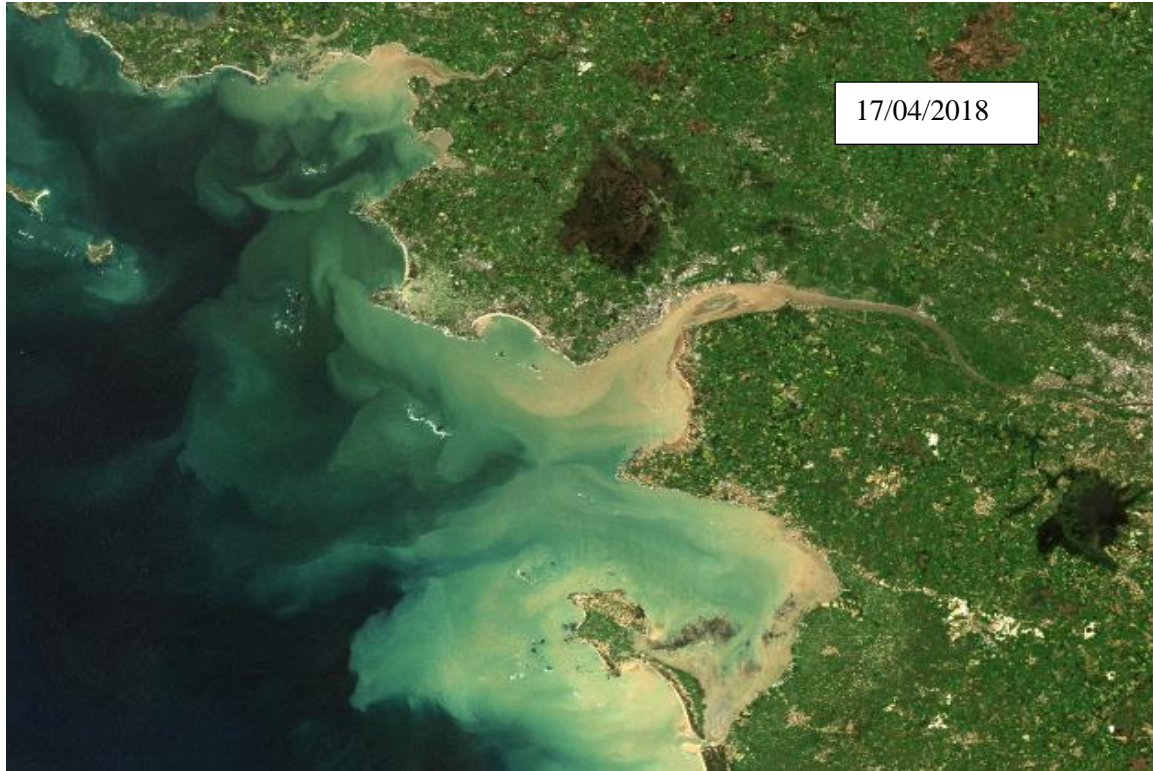
Figure 22 : Illustration de la remise en suspension des particules fines par la houle (Sentinel 17/04/2018).
