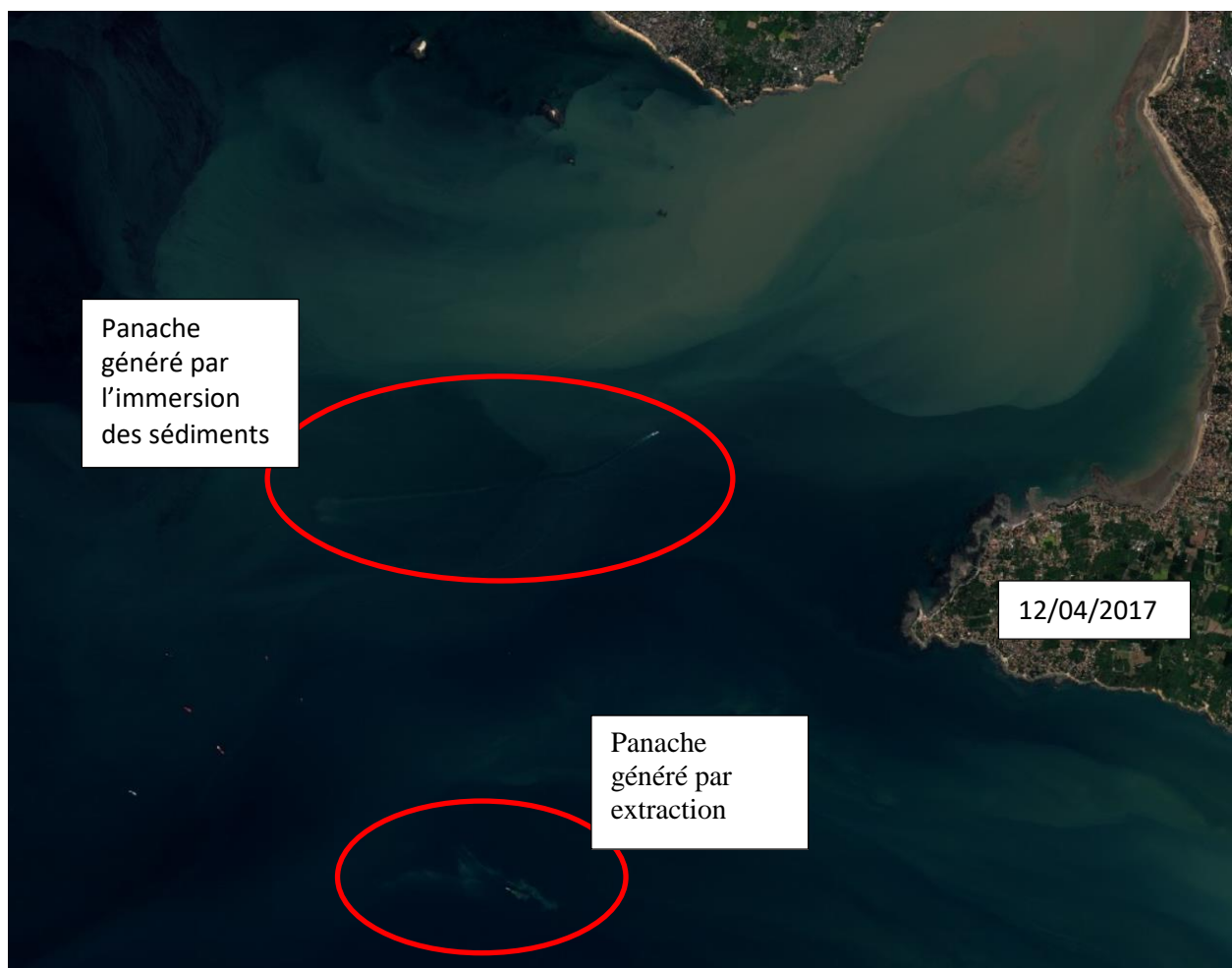
Figure 21 : Image satellite montrant l'emprise spatiale du panache turbide de la Loire (Sentinel 12/04/2017) et ceux des activités d'immersion de sédiment sur le site de la Lambarde et d'extraction de sédiment sur le site du Pilier.
