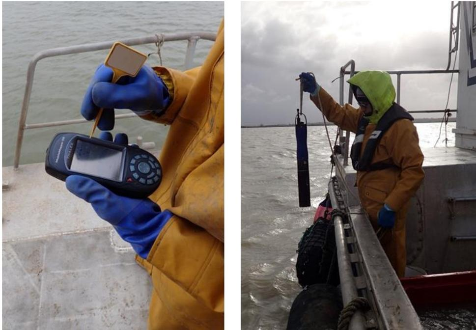
Figure 5 : Enregistrement du tracé du chalut sur GPS mobil mapper et mise à l'eau de la sonde EXO.
