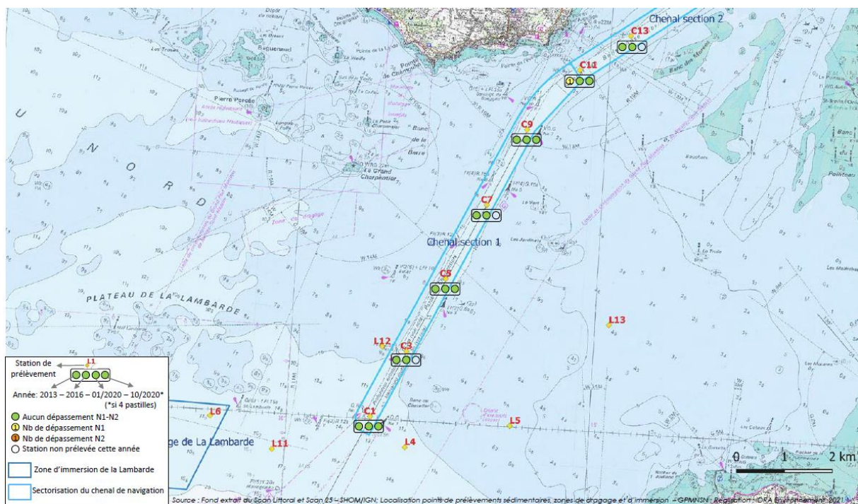
Figure 25 : Exemple de cartographie de la qualité des sédiments vis-à-vis des seuils N1/N2 dans le chenal de navigation (IDRA, 2021)
