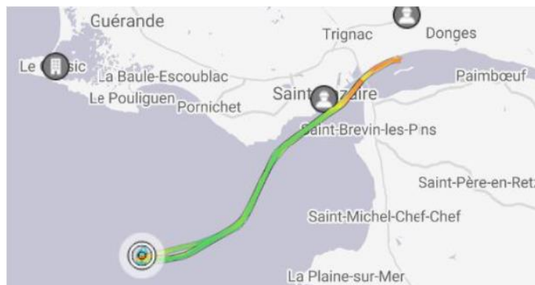
Figure 17 : Cycle de dragage depuis la section 5 (1 h de dragage, 2h30 de trajet A/R)
