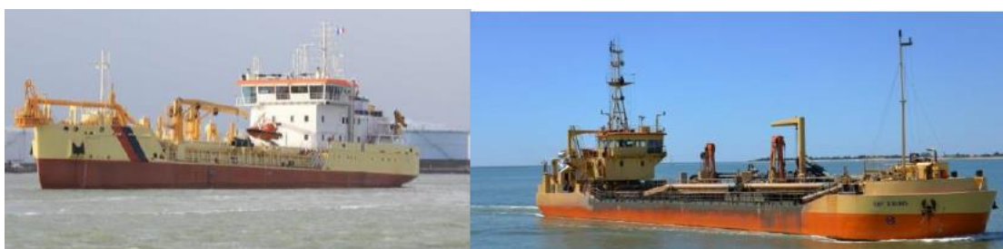
Figure 20 : Dragues de petite capacité en puits : DAM "Jean Ango" et Cap d'Aunis (marinetraffic.com)
