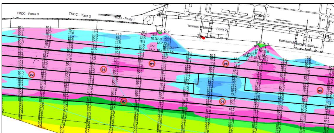
FIGURE 36 PLAN DE TRAVAIL POUR UNE DRAGUE ASPIRATRICE EN MARCHÉ – SEDIMENTS DEPOSES EN PHASE DE CONSOLIDATION, ZONES TRES ETENDUES
