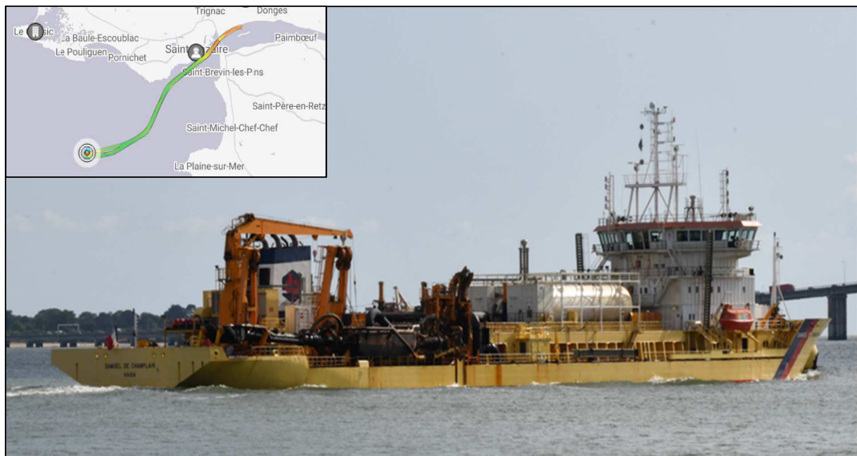
FIGURE 17 CYCLE DE DRAGAGE DEPUIS LA SECTION 5 (1 H DE DRAGAGE, 2H30 DE TRAJET A/R) ET DAM « SAMUEL DE CHAMPLAIN » (SOURCE : GPMNSN)
