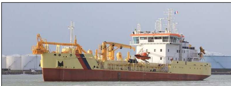
FIGURE 17 EXEMPLE DE DRAGUE DE PETITE CAPACITE EN PUIITS : DAM "JEAN ANGO" (MARINETRAFFIC.COM)
