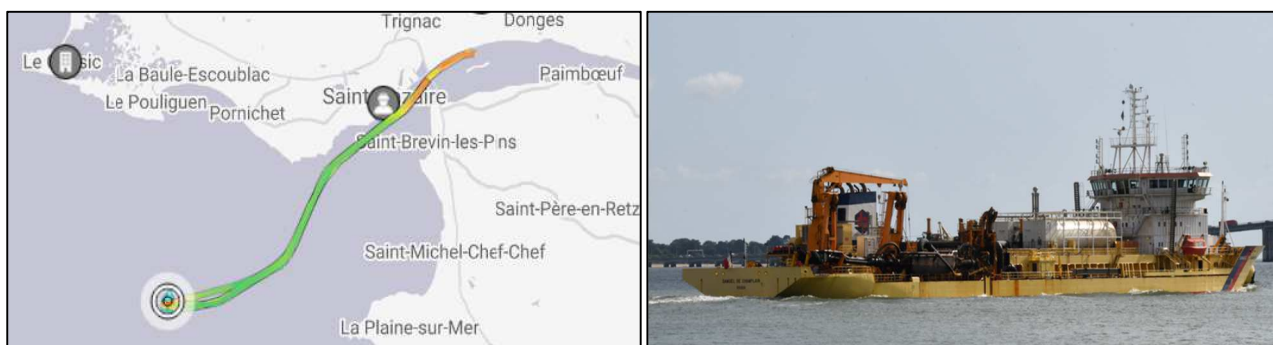
FIGURE 14 CYCLE DE DRAGAGE DEPUIS LA SECTION 5 (1 H DE DRAGAGE, 2H30 DE TRAJET A/R) ET DAM « SAMUEL DE CHAMPLAIN » (SOURCE : GPMNSN)
