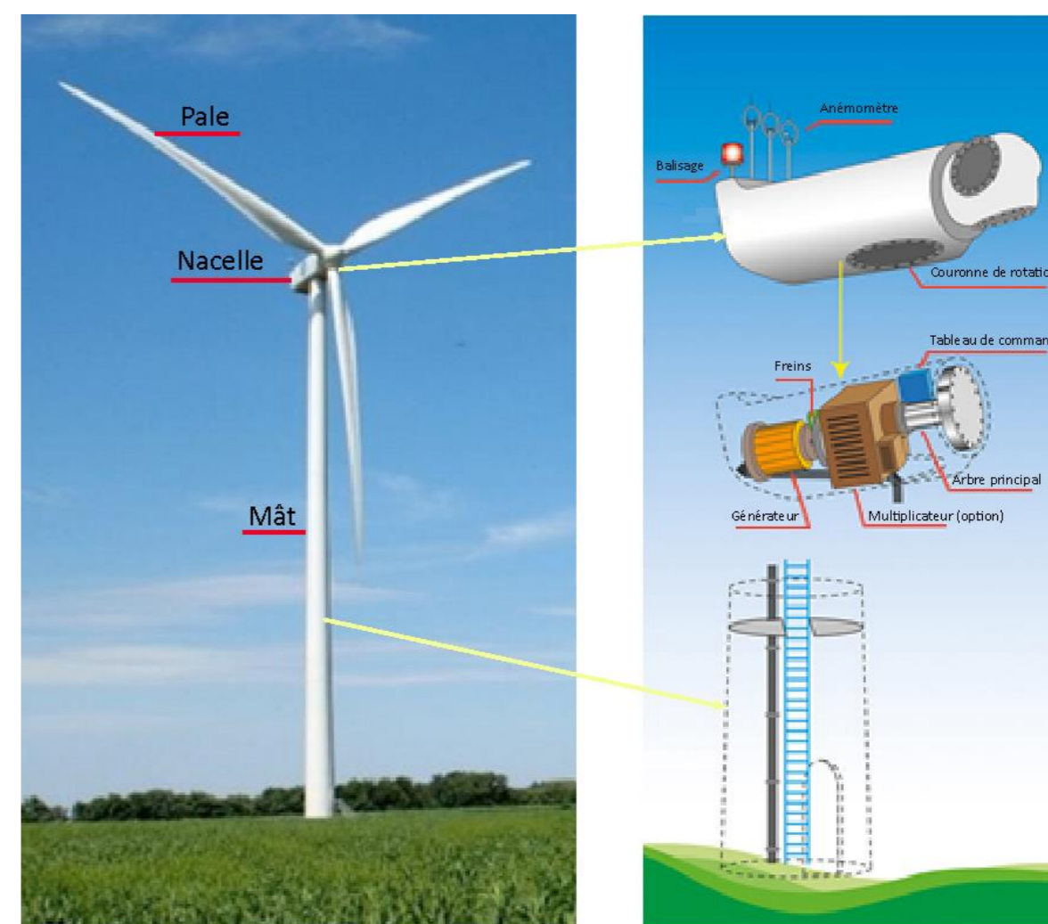
Figure 4 : éléments constitutifs d'une éolienne
