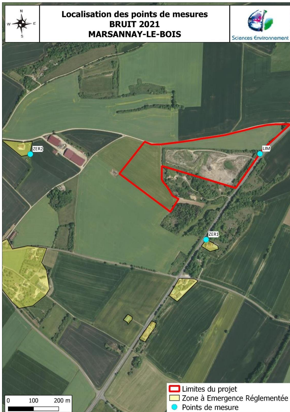
Figure 59 : Plan de localisation des points de mesures des émissions sonores au niveau du site d'extraction et en limite des Zones à Emergence Réglementée (ZER).
