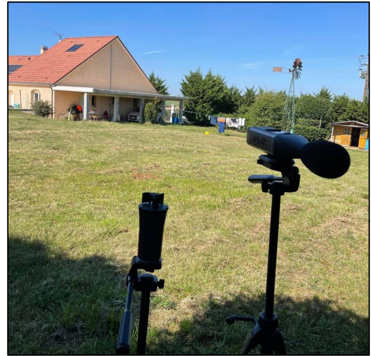
Figure 62 : Photographie du sonomètre lors de la mesure du niveau sonore initial en limite ZER (point ZER-2 sur la Figure 52)
