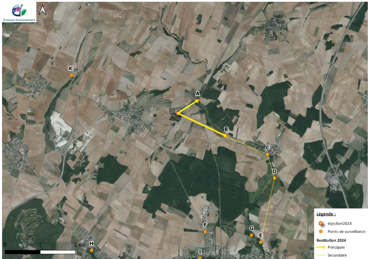
Figure 16 : Restitution de fluorescéine (photographie aérienne)
