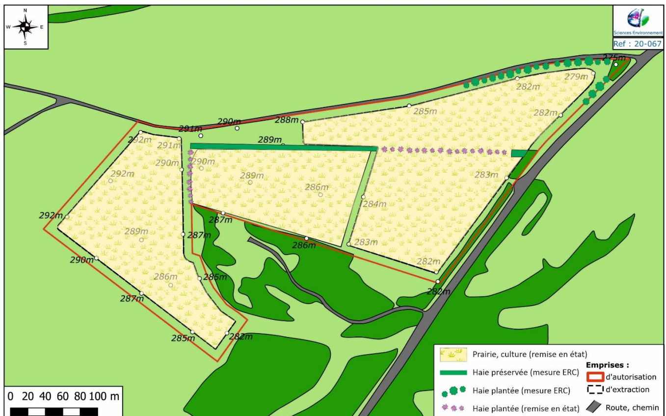
Figure 5 : Principes de la remise en état
