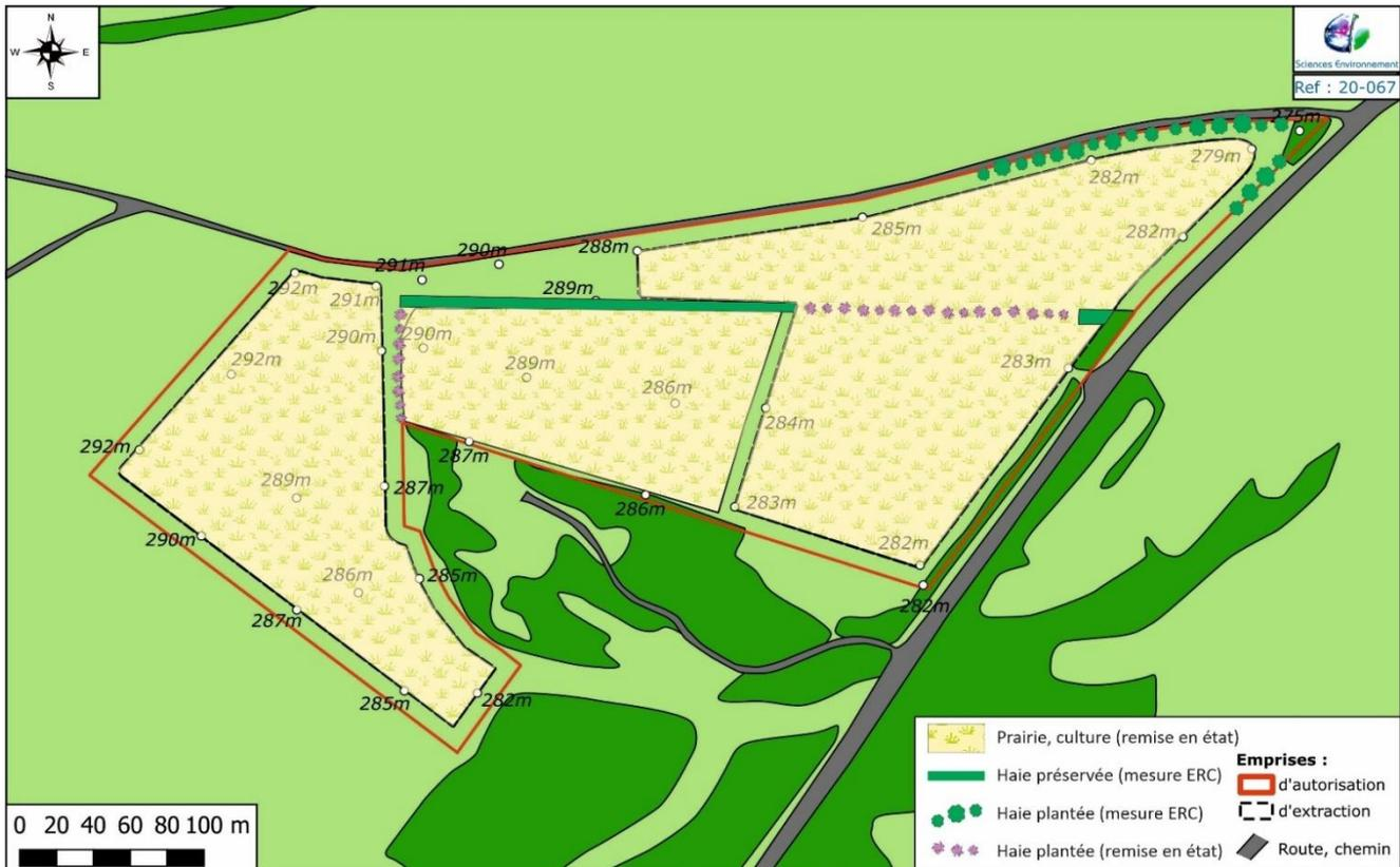
Figure 1 : Principe de remise en état de la carrière de Marsannay-le-Bois
