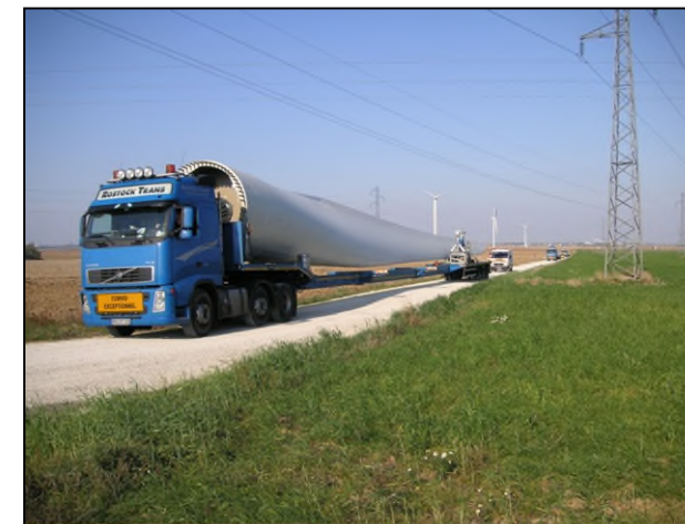
Figure 13 : Acheminement et stockage des éléments de l'éolienne
