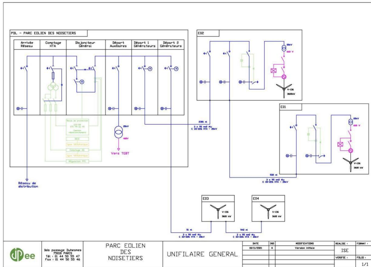
Figure 12 : Schéma de principe du poste de livraison envisagé pour le projet éolien des Noisetiers
