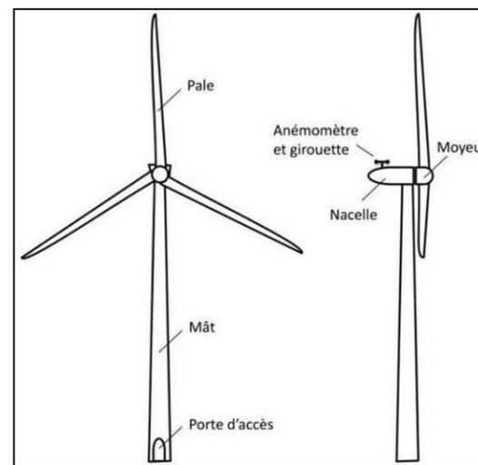
Figure 1 : Schéma simplifié d'une éolienne
