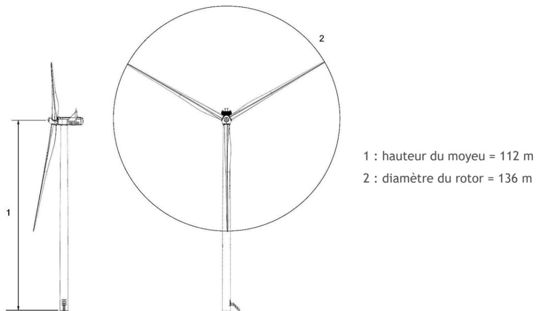
Figure 3 : Schéma des dimensions de l'éolienne Vestas V136
