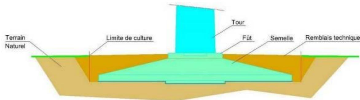
Figure 5 : Schéma type d'une fondation
