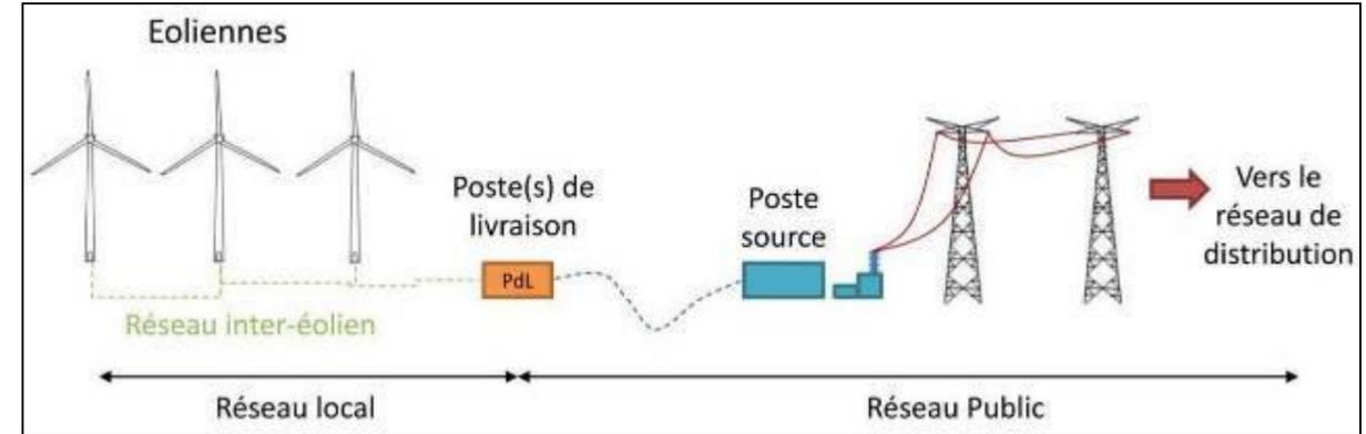
Figure 10 : Principe de raccordement électrique d'une installation éolienne (Source : Ineris)
