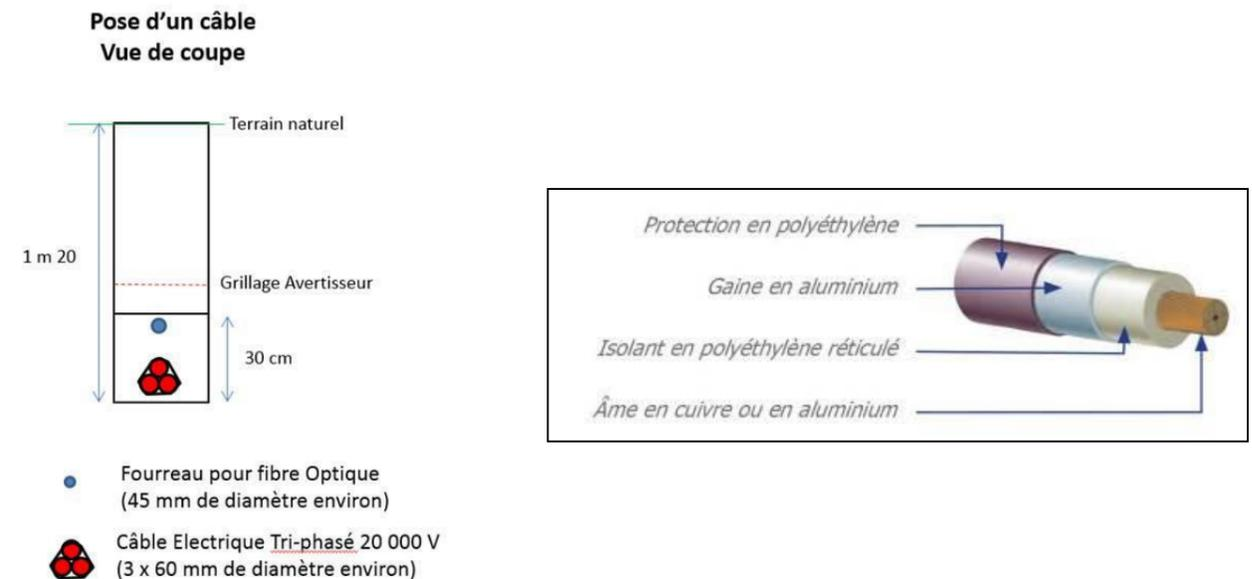
Figure 11 : Principe d'enfouissement et coupe d'un câble de raccordement souterrain (source : RTE)
