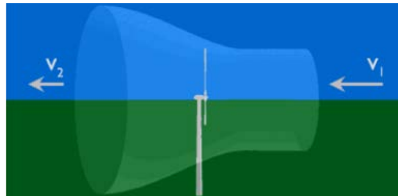
Figure 109 : Modification du vent au passage d'une éolienne 62
