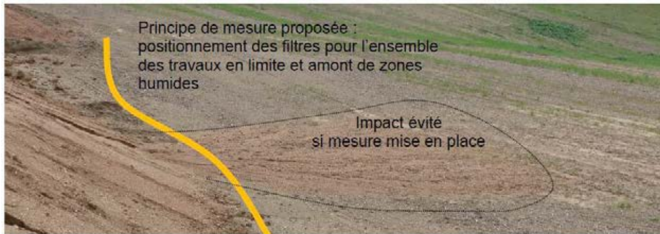
Photo 20 : Exemple d'impact évité par la mise en place d'une barrière hydraulique
