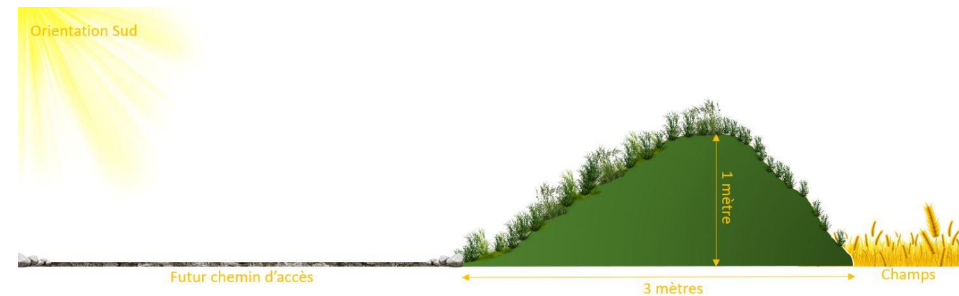
Figure 84 : Schéma du talus créé pour la mesure compensatoire C1
