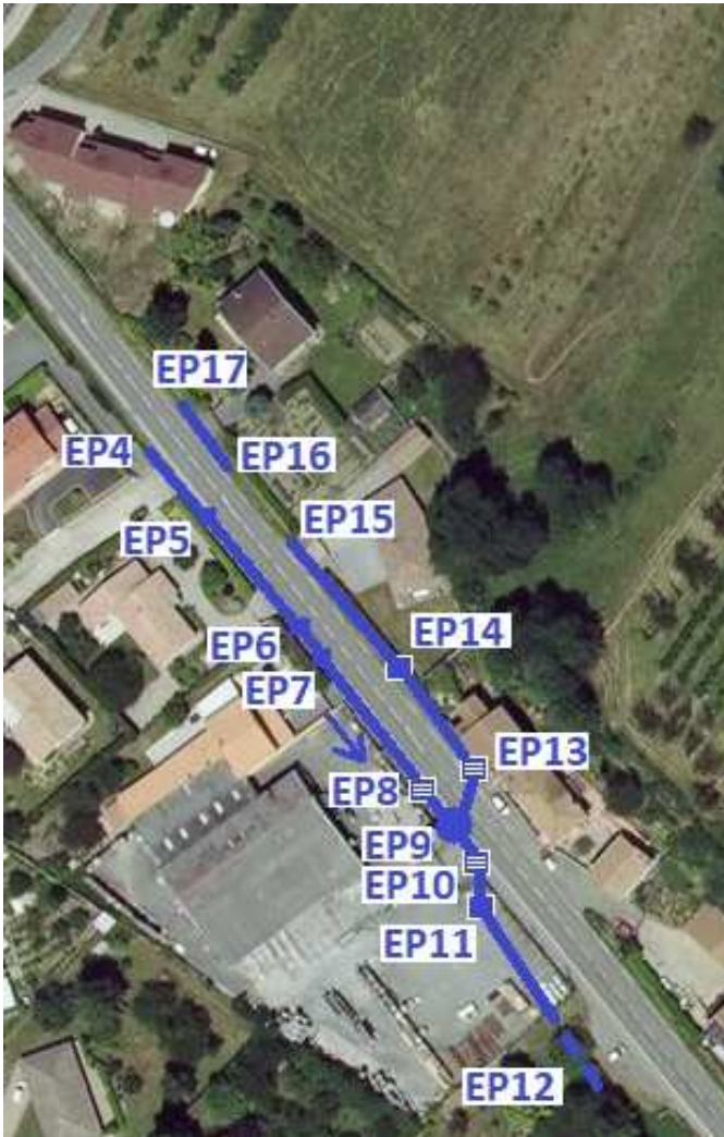
Figure 10 : Réseau à remplacer RD538 – Secteur St Benoît
