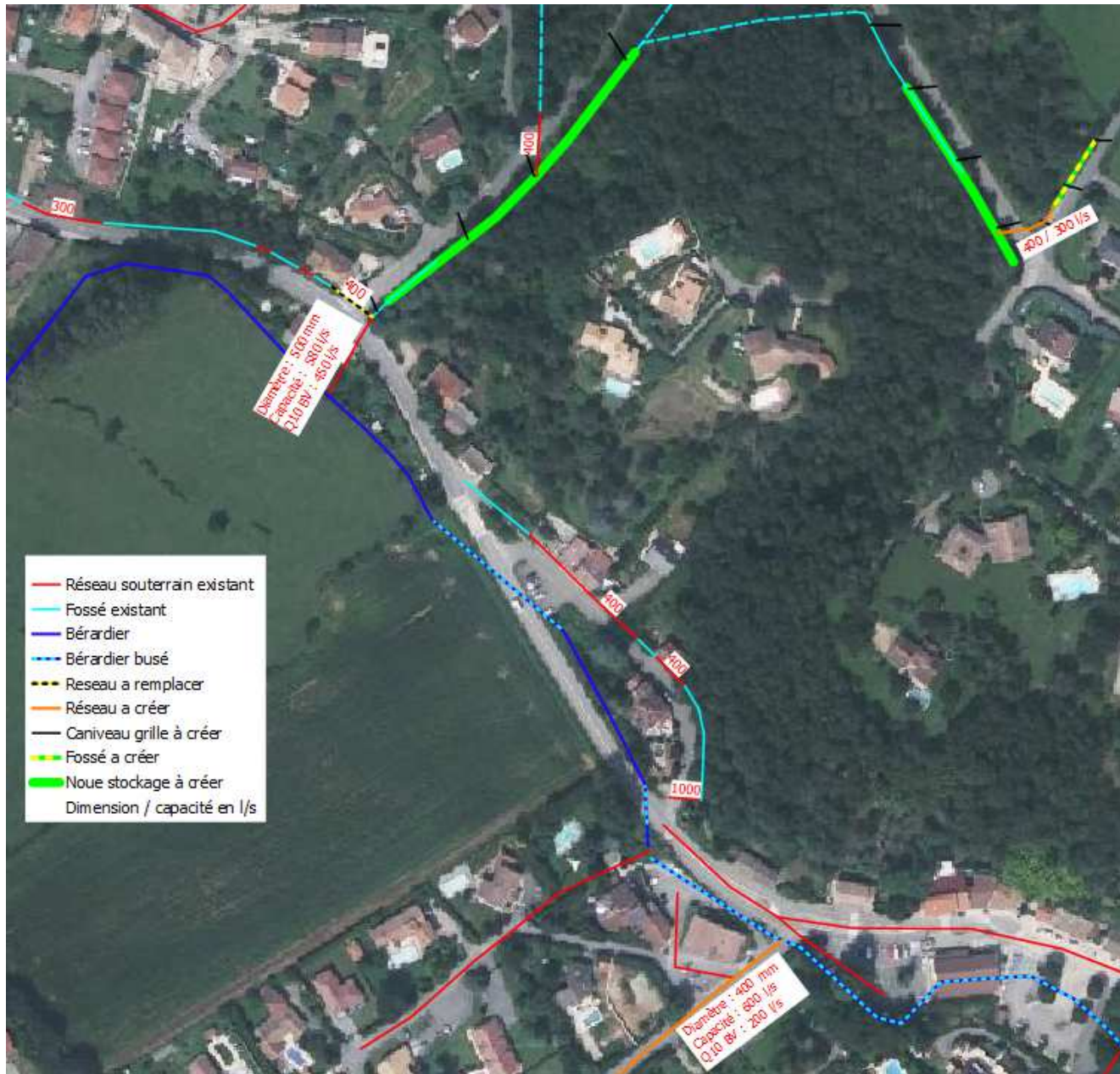
Figure 21 : Caractéristiques des ouvrages de collecte principaux : diamètre (en mm) / capacité – partie aval
