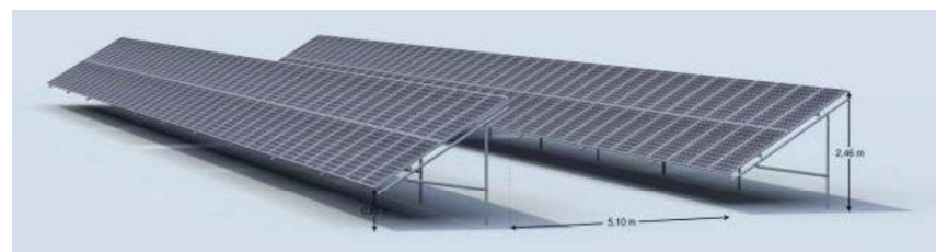
Figure 4: Schéma de principe de l'agencement des tables d'assemblage
