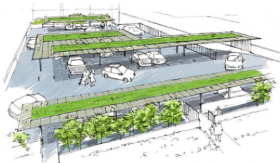
Exemple de parc de stationnement paysager sous pergola/ombrières avec panneaux photovoltaïques et treilles végétalisées.
