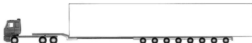
Figure 27 : Transport d'un mât
