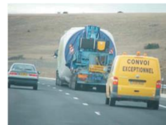
Photographie 8 : Acheminement d'une nacelle par convoi exceptionnel jusqu'au chantier (Source : EDF Renewables)
