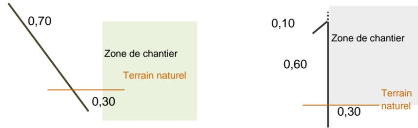
Figure 115 : Principe et caractéristiques des clôtures contre l'intrusion des amphibiens
