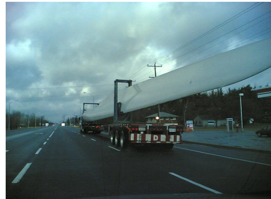
Photo 7 : Camion de transport des pales d'une éolienne
