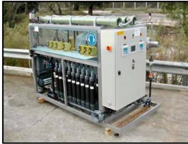
Exemple d'unité de potabilisation mobile (Polymem)
