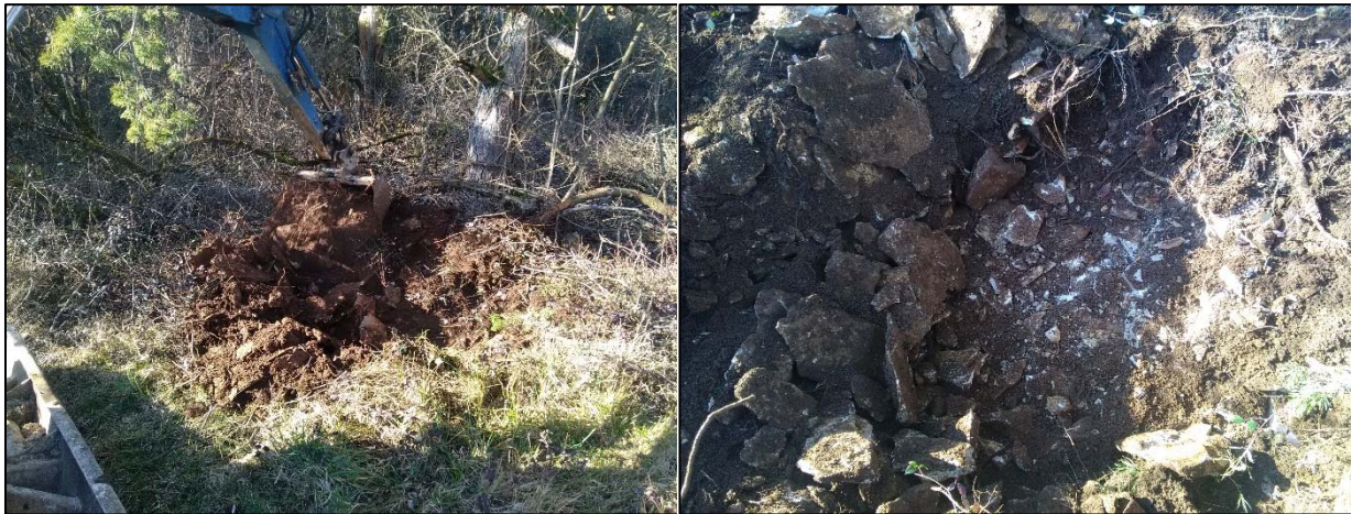
Figure 10 : Fosse d’injection de l’éosine
