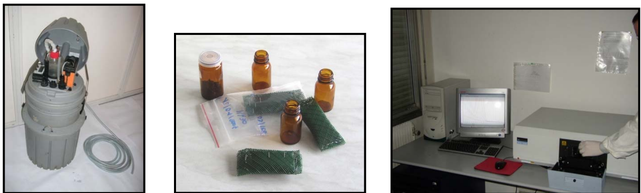
Figure 4 : Préleveur automatique ; Fluocapteurs ; Spectrofluorimètre LS-50B
