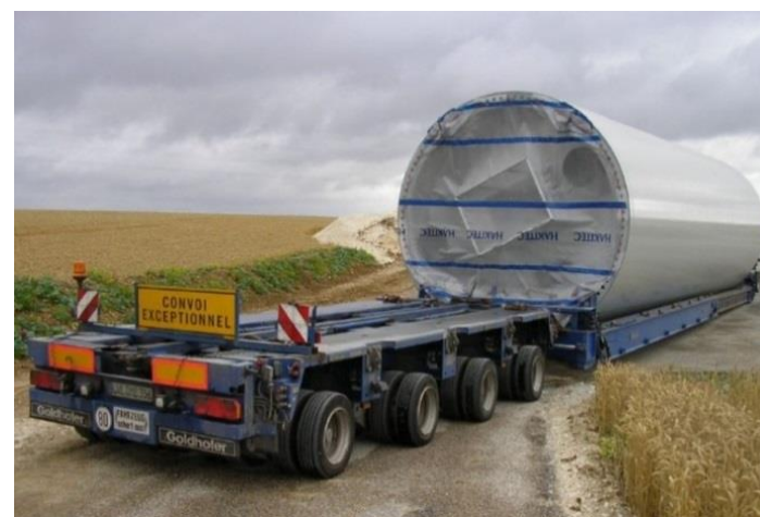
Photo 5 : Transport d'une section de tour d'une éolienne sur site
