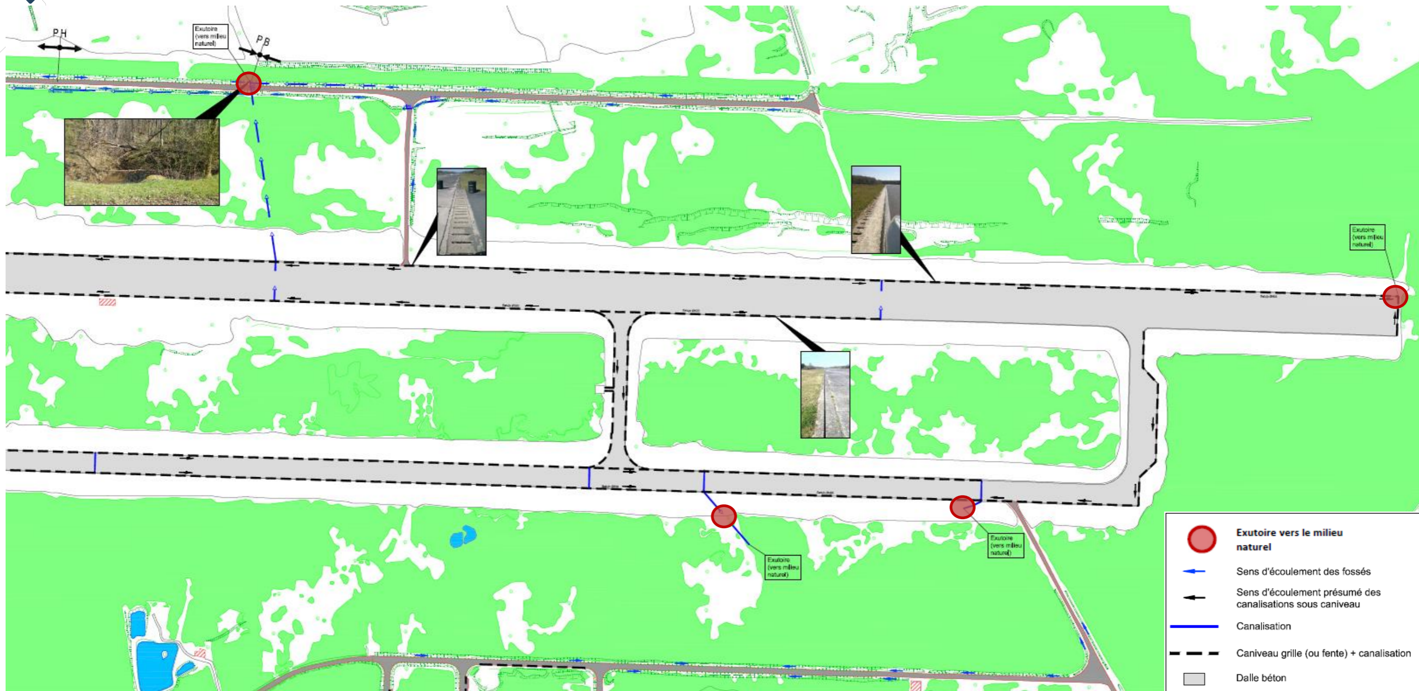
Carte 10 : Plan des principes d'assainissement existants – partie Est (source : Département des Ardennes)
