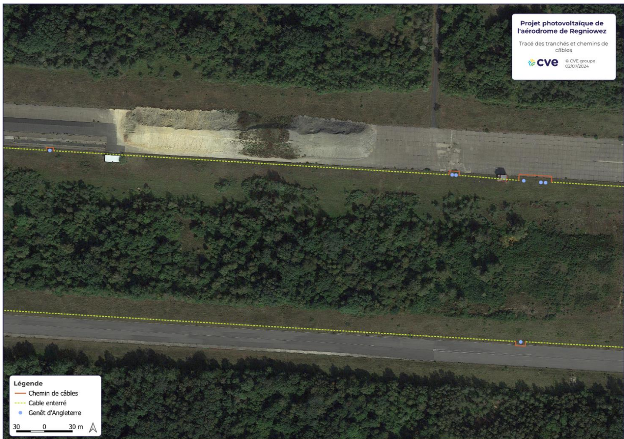
Figure 5 : exemple de carte du tracé des tranchées et des chemins de câbles
