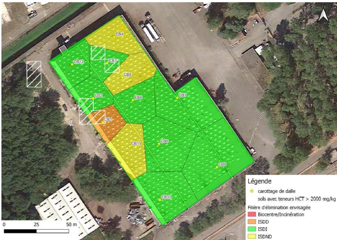
Figure 6 : Zonage des filières d'admission – dallage partie inférieure
