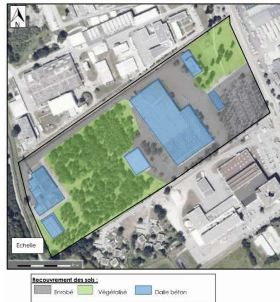
Figure 7 : Recouvrement des sols au niveau de la zone d'étude (Source : Rapport d'étude INGEOS n° D4737-20-001-Ind0, en date du 30 septembre 2020, relatif à l'évaluation environnementale dans le cadre d'une cessation d'activité : Etude historique, documentaire & mémorielle - mission INFOS (A100-A110-A120-A130) selon la Norme NF X 31-62)
