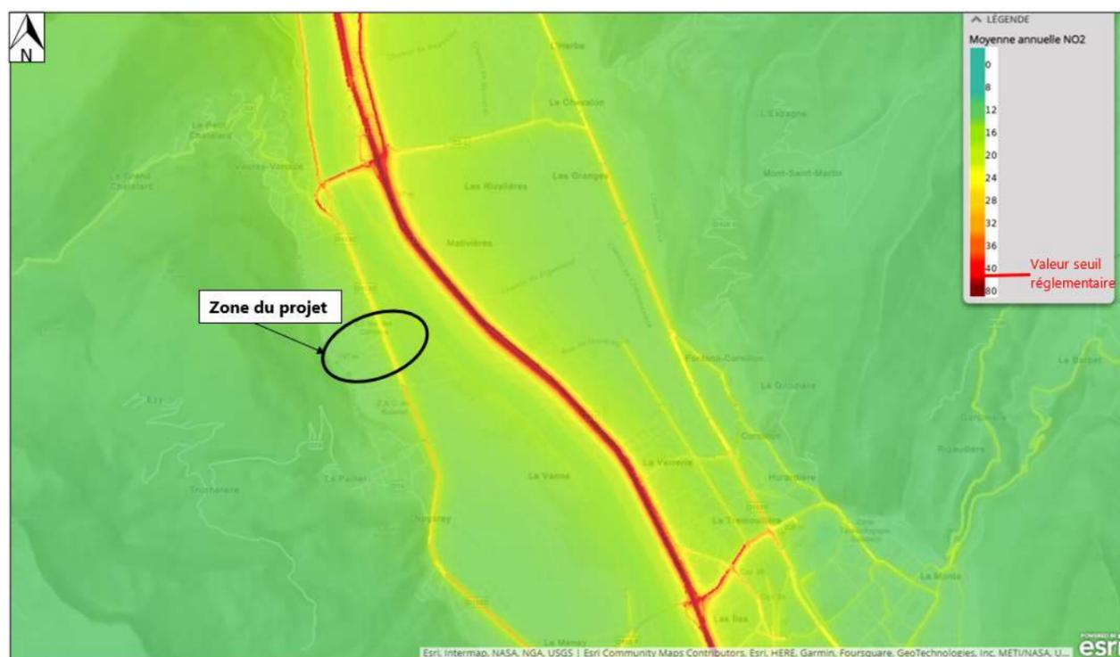
Figure 17 : Cartographie des concentrations moyennes annuelles en dioxyde d'azote en 2019 – Modélisées par Atmo Aura
