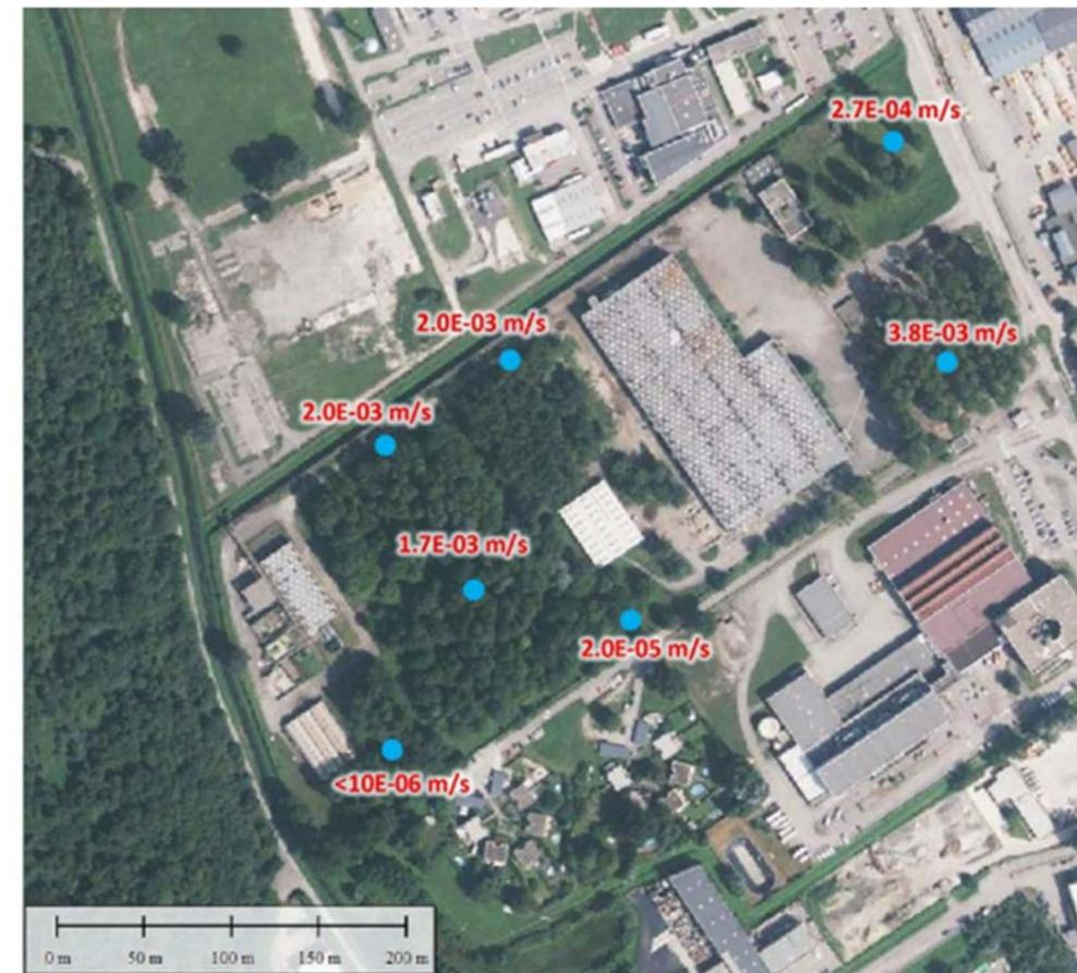
Figure 102 : Perméabilité mesurée par l'étude géotechnique
