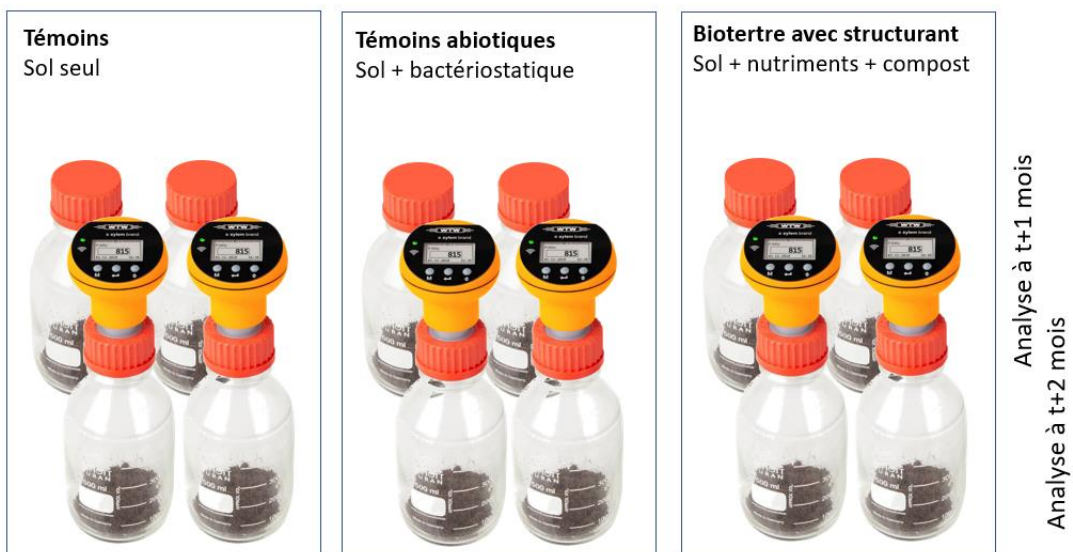
Figure 4 : Représentation schématique des essais de traitabilité en bioterre
