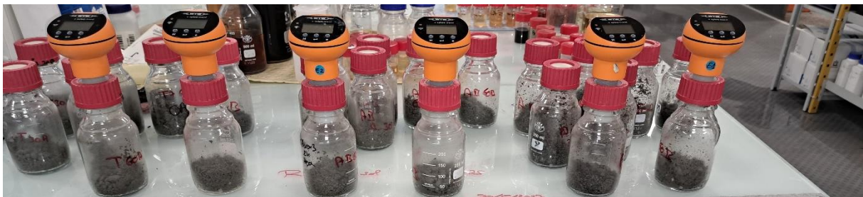
Figure 7 : Essais de traitabilité en bioterre
