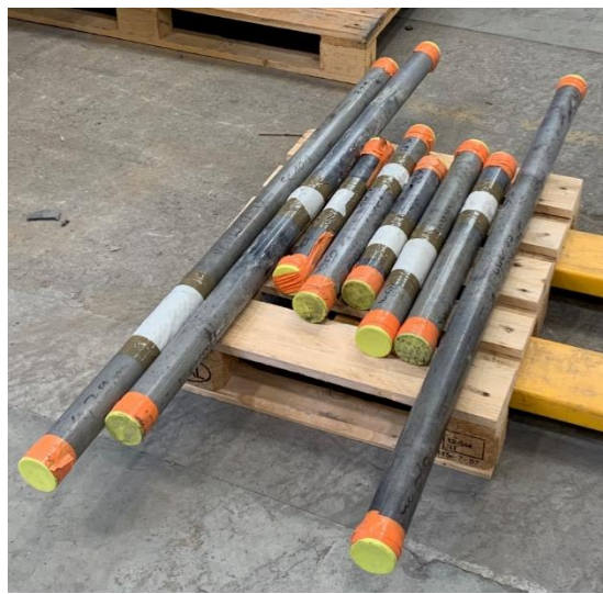
Figure 3 : Carottes reçues sous gaine
