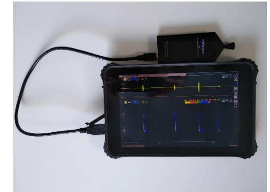
Photo 1 - Détecteur ultrasons Pettersson M500 et logiciel « Batsound Touch » sur tablette Source : Photo Althis
