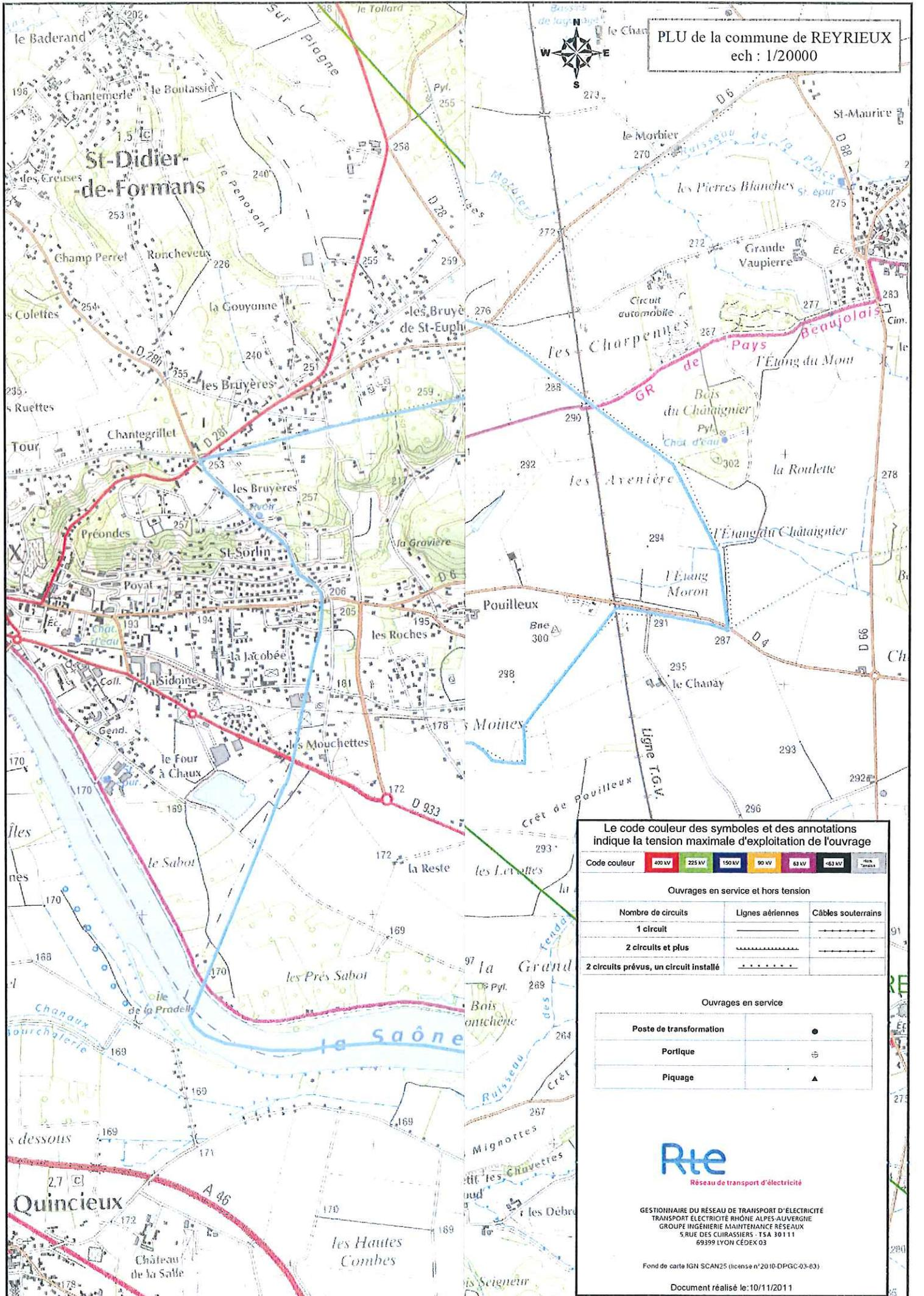
Le code couleur des symboles et des annotations indique la tension maximale d'exploitation de l'ouvrage
