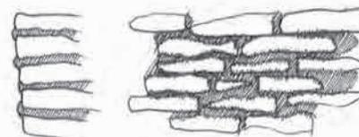
Placages rapportés, matériaux mis en oeuvre de façon rapportée, scellée ou agrafée : solutions à éviter, le rendu final produit dans la plupart des cas un effet artificiel, sans l'effet de masse recherché.
