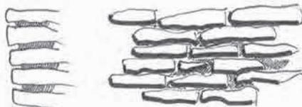
Joints avec finition tirée au fer sur le corps d'enduit encore frais
