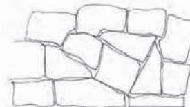
Joints trop saillants, exécutés avec dépassement de mortier, encore appelés "beurrés"
