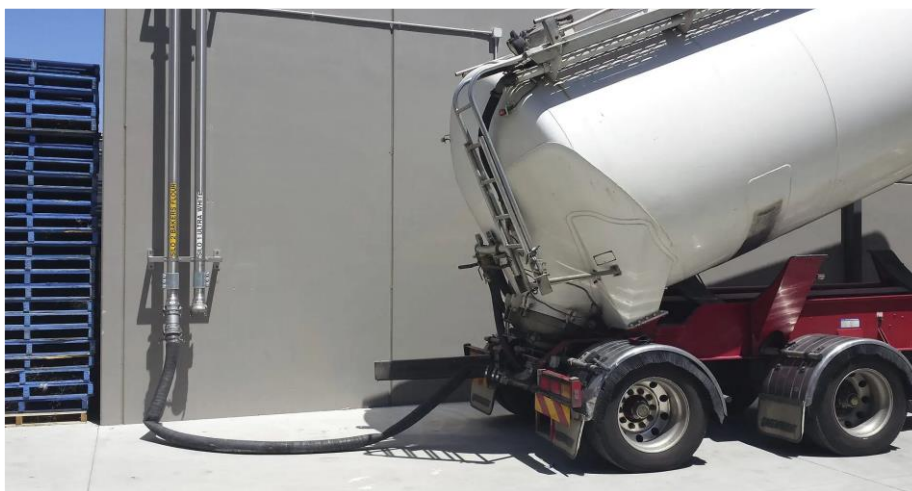
Exemple de citerne de vrac en cours de dépotage (Photo non contractuelle)
