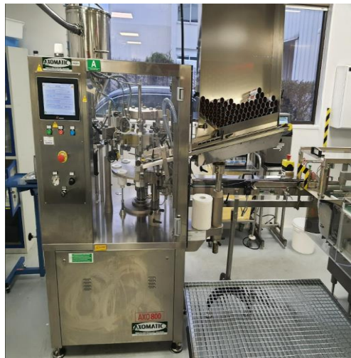
Equipement de répartition qui permet le remplissage des tubes (Opération de conditionnement primaire, photo non contractuelle)
