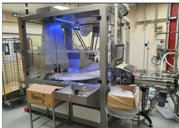
Robot manipulateur de flacons (Photo non contractuelle)
