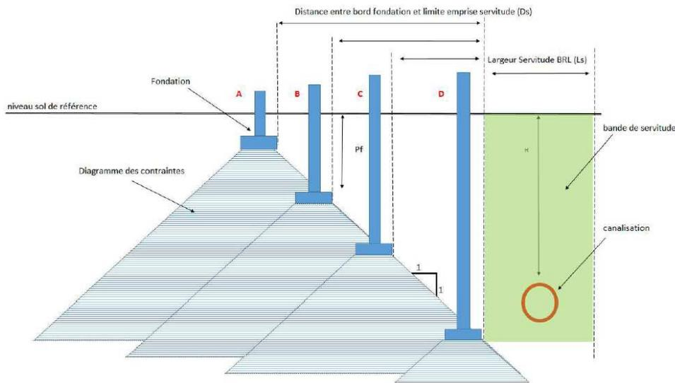
**Suggestion emprise de sécurité et distance minimum entre canalisation et 1<sup>ère</sup> construction \***
