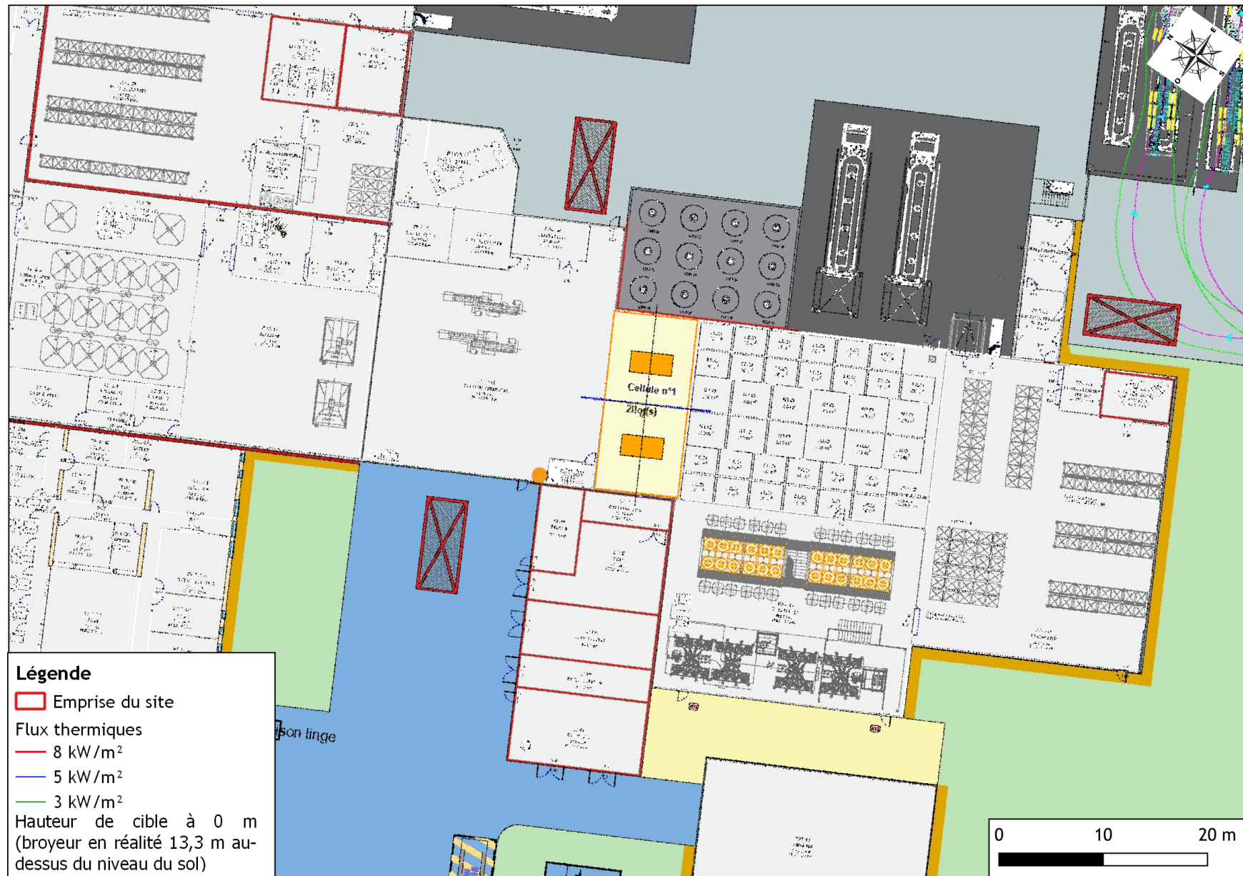
Figure 11. Modélisation de l'incendie des broyeurs Petfood
