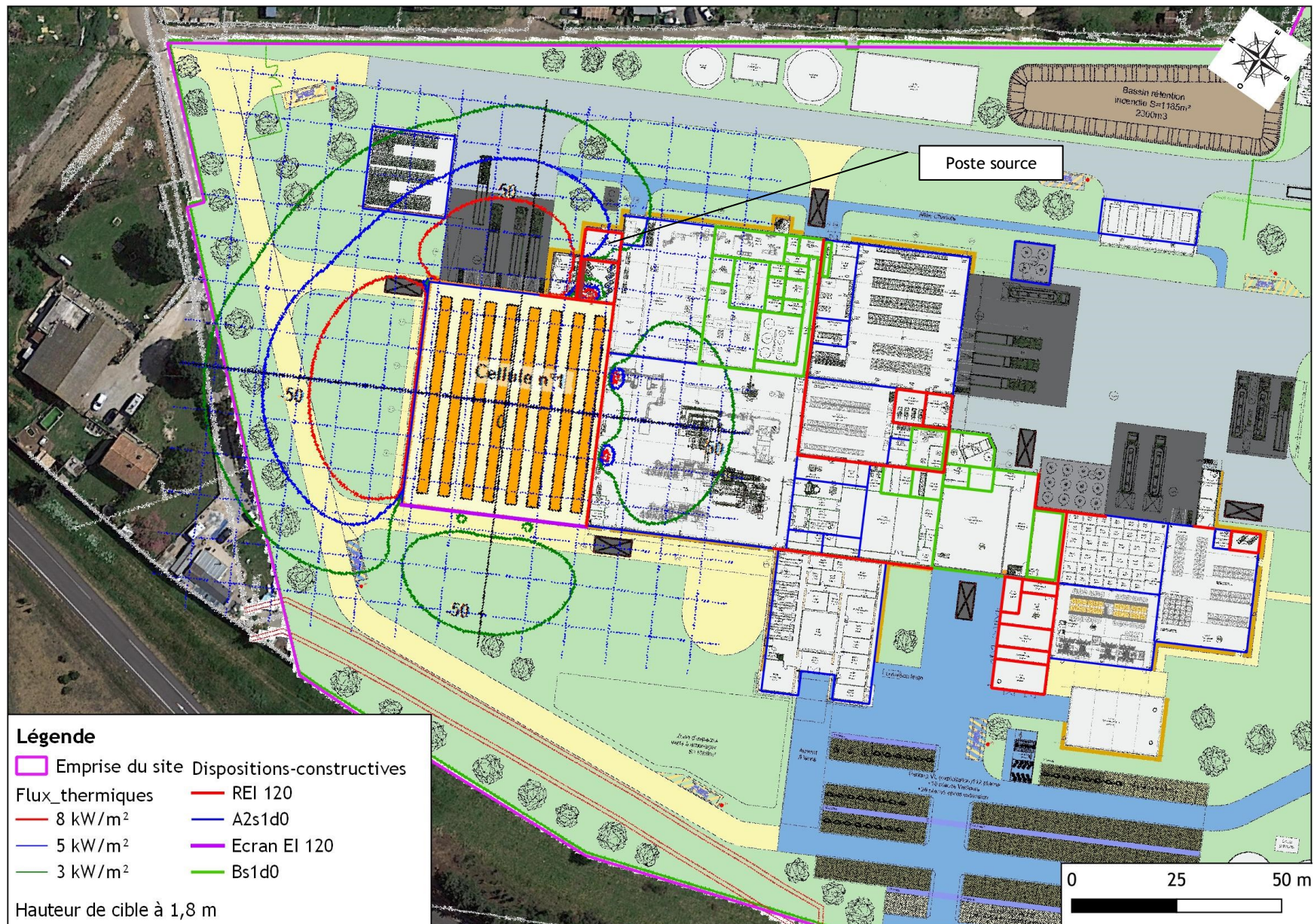
Figure 16. Modélisation de l'incendie du stockage de produits finis
