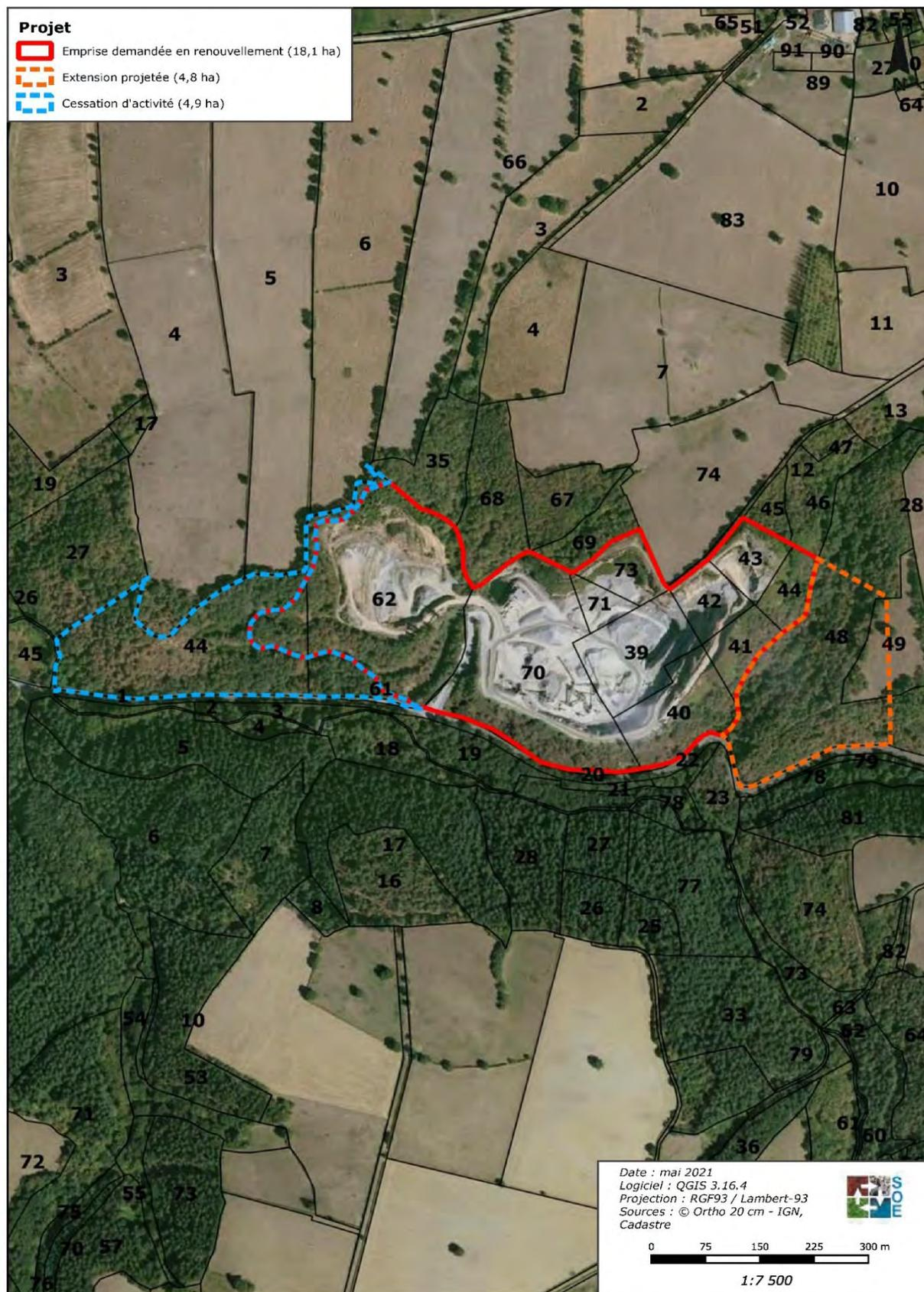
Figure 4 : Localisation des zones d'extension, de renouvellement et d'abandon partielle
