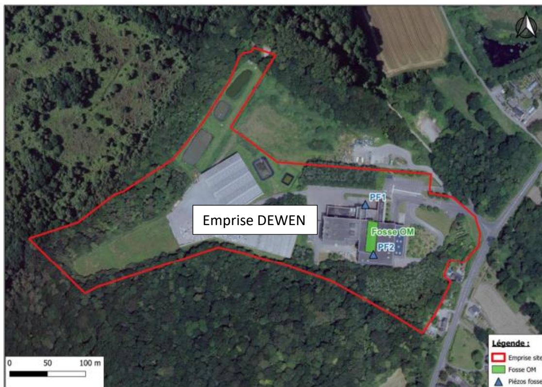
Figure 4 : localisation des piézomètres installés (sur fond de vue aérienne de Géoportail)
